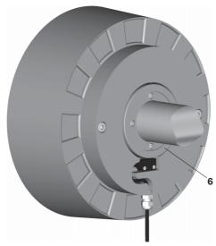
Zulässiger Axialversatz der Sensorscheibe ( $\mathbf{6}$ ) =  $\pm 2$  mm Max. permissible axial run-out of the sensor disk ( $\mathbf{6}$ ) =  $\pm 2$  mm
